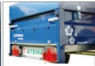
allseitig geschützte Multifunktions-leuchten / impact-proofed multifunctional rear lights
